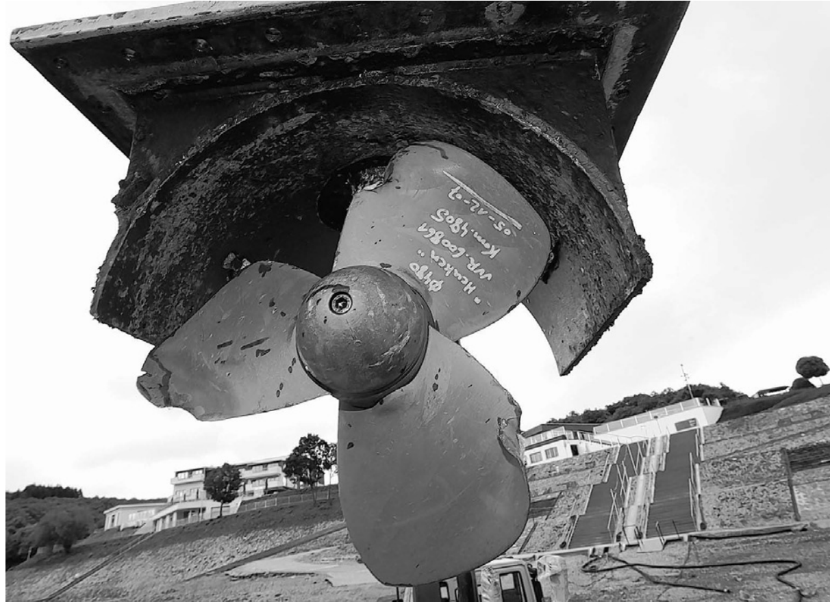
Das Bugrad der „Stella Maris“ ist bei einem Anlegemanöver beschädigt worden. Inzwischen wurde es ausgebaut und wird von einer Spezialfirma in Boppard repariert. Foto: Manfred Hilgers
